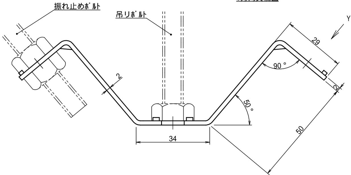
吊りボルト・振れ止めボルトは、W 3 / 8 に適用します。
